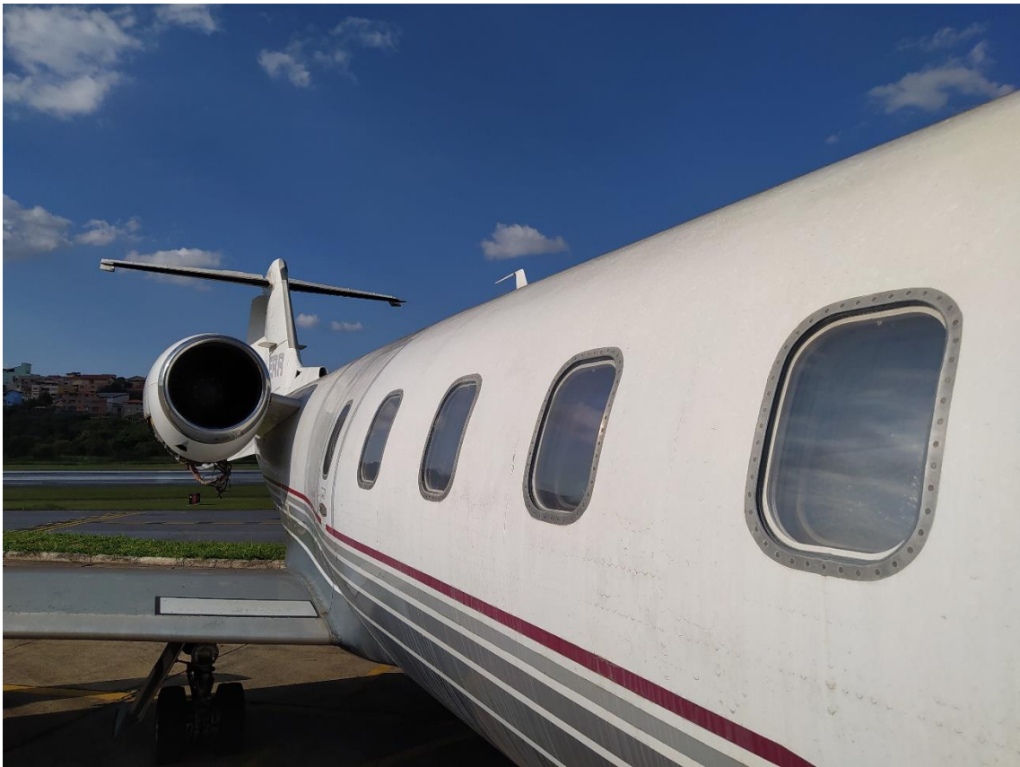
Motores sem proteção no bocal de entrada de ar
