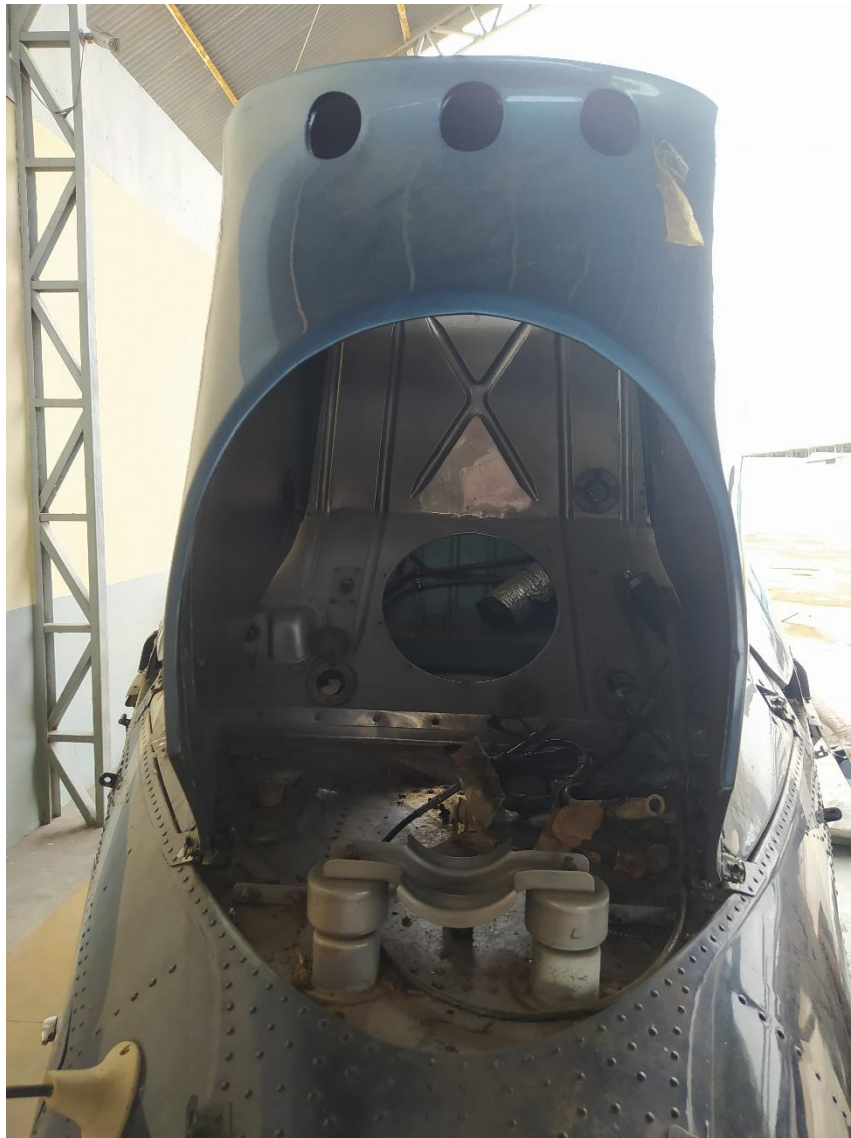
Imagem do acoplamento do cone de cauda
